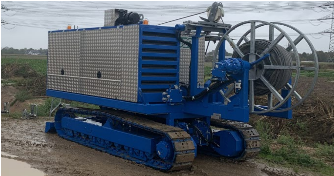
Abb. 4-15: Beispiel für ein Kabelzugerät auf selbstfahrendem Raupenfahrwerk
